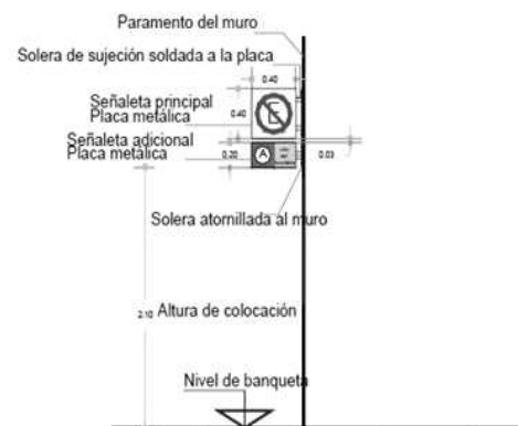
Señaleta compuesta sobre muros
